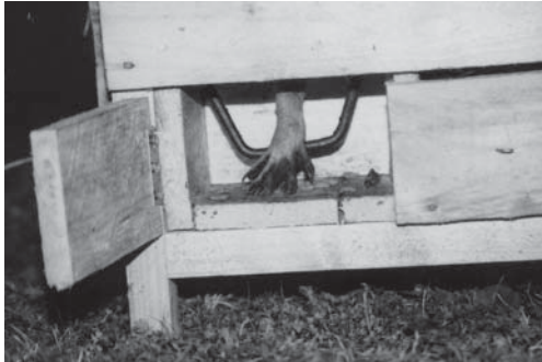
Abb. 1 Bei geöffneter Futterklappe wird der Schwenkmechanismus der verwendeten Fallen innerhalb der Futterbox sichtbar. Bewegte ein Waschbär mit seinen Vorderpfoten die Schwenkvorrichtung, wurde der Schließmechanismus ausgelöst. (Foto F. Michler)
